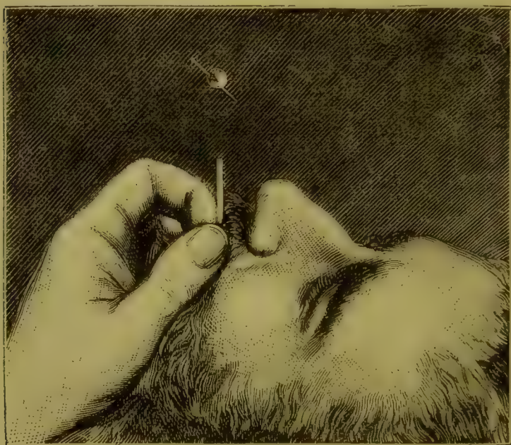
Fig. 82. Pisello attraversato da uno spillo sostenuto in aria con un soffio.
